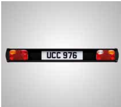
Pannello portatarga posteriore con luci Robusto pannello portatarga posteriore con luci, dotato di ingresso a 13 poli ISO e di 8 metri di cavo. Dal design pulito, comprende la luce di retromarcia e dei fendinebbia posteriori, due luci di coda, gli indicatori di direzione e la luce di arresto.
