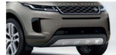
**Piastra di protezione sottoscocca in acciaio inossidabile – Anteriore e Posteriore**
